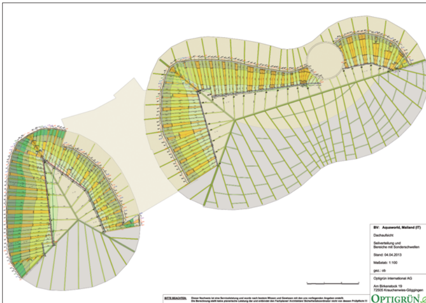
Draufsicht Aqua-World mit dem eingezeichneten Schubsicherungssystem ...
